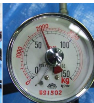
M12 引抜き強度 1950 kg (メーカー試験値 1420 kg)
