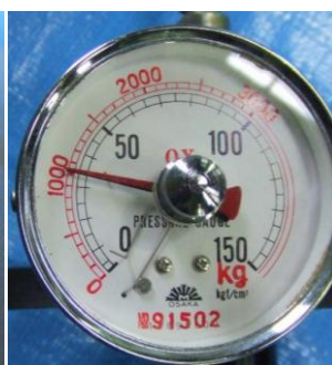
M10 引抜き強度 1020kg (メーカー試験値 740 kg)
